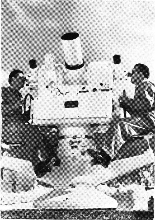
*Fototeodolite di fabbricazione svizzera, utilizzato dall'Inghilterra al Centro sperimentale sull'impiego di razzi, in Australia: con lo stesso è possibile seguire il percorso di razzi con una precisione prima non raggiunta.*
