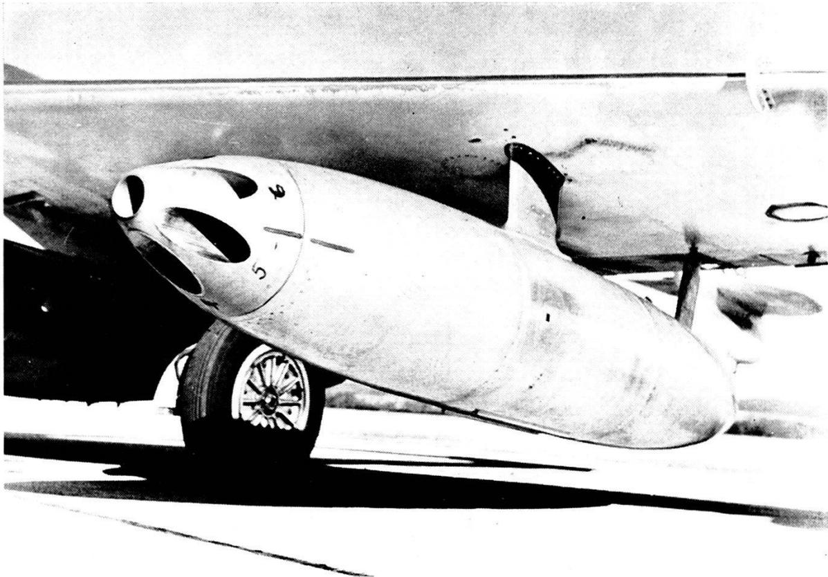
Telaio lanciarazzi sperimentale a 7 tubi in fascio « Oerlikon.
