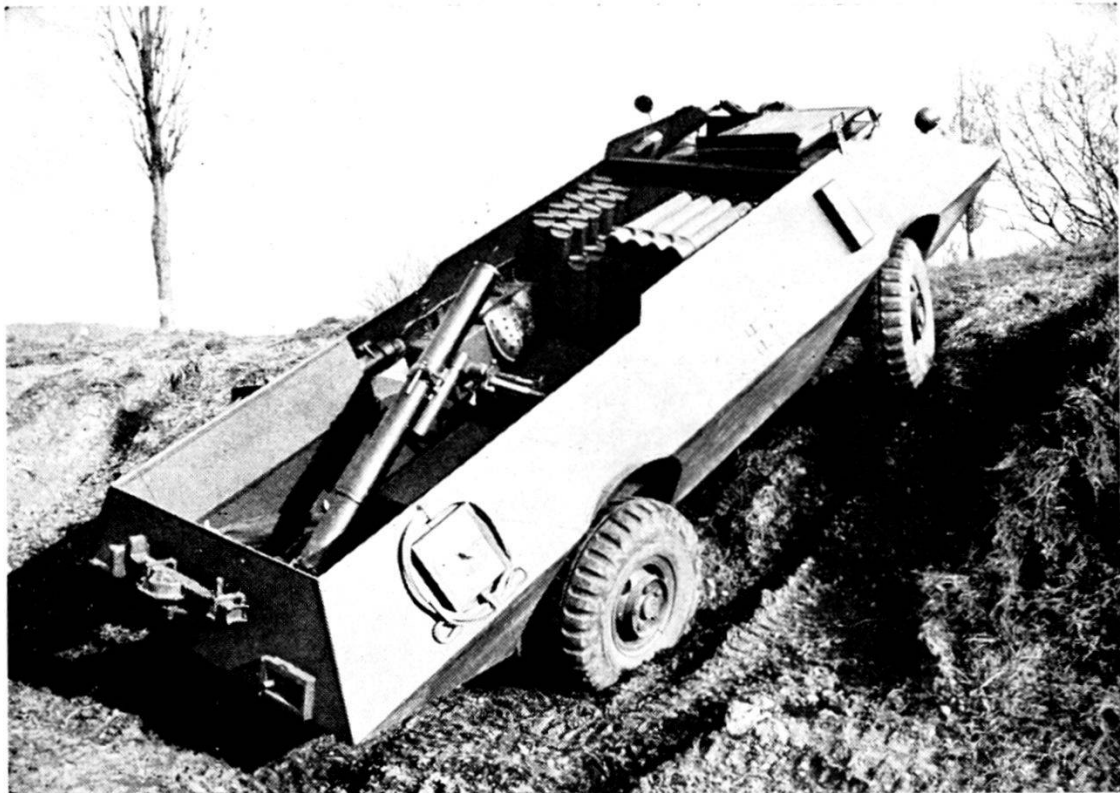
Svizzera: lanciamine pesante 12 cm semovente (scafo « MOWAG »)
