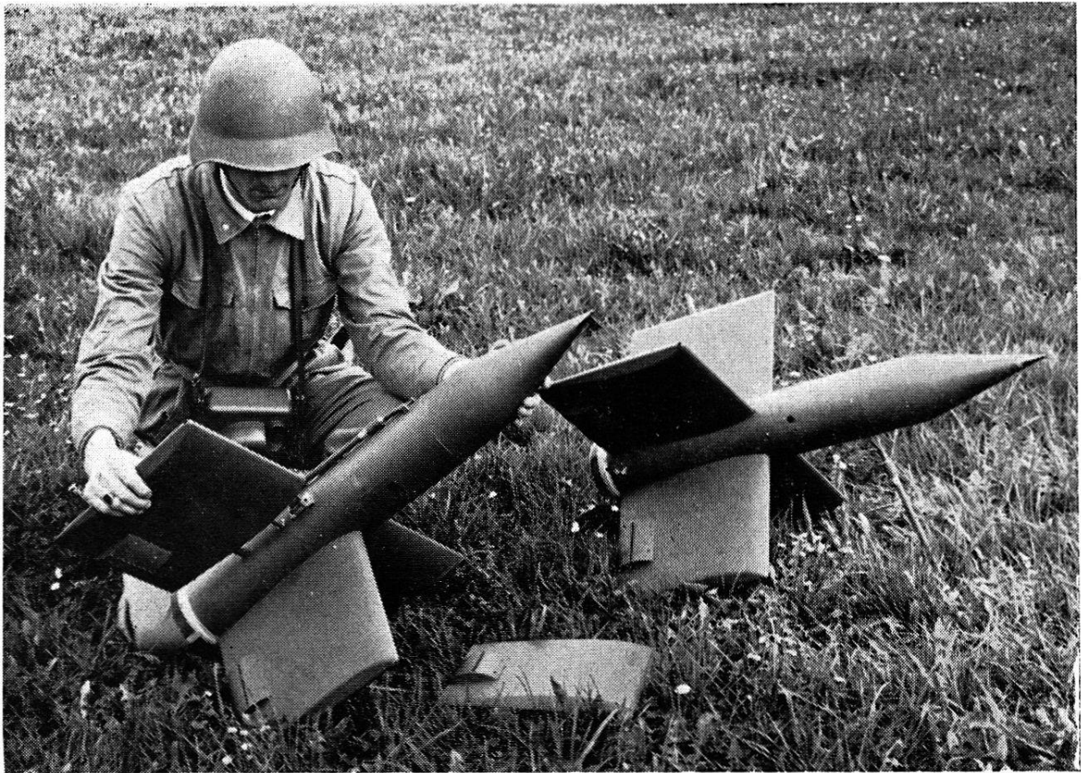
Tiratore durante il montaggio delle ali
