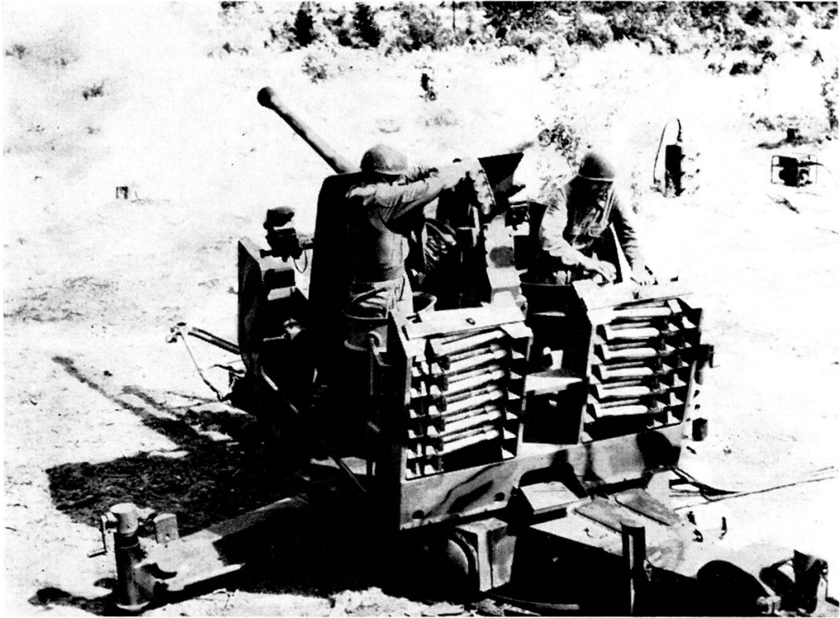
Cannone antiaereo automatico « BOFORS », cal. 40 mm in azione
