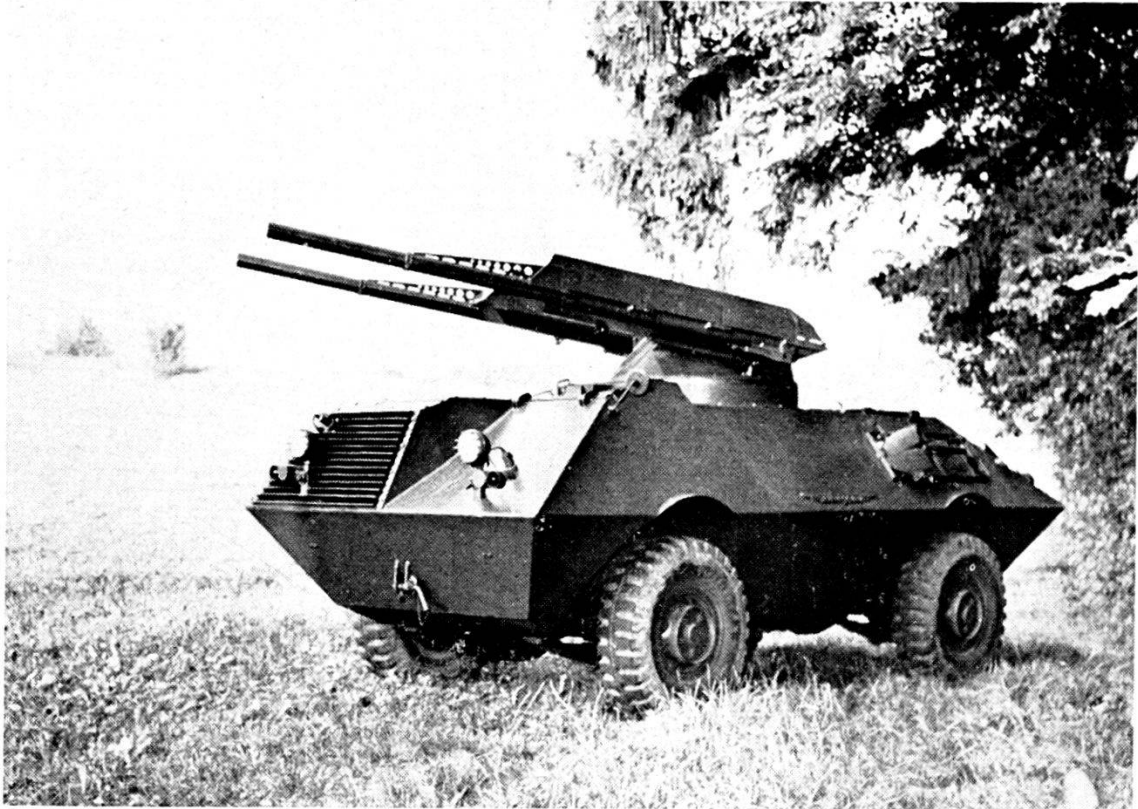
Lanciarazzi gemellato automatico Oerlikon su scafo Mowag Cal. 8 cm. - Possibilità di tiro rapido a 8000 m.
