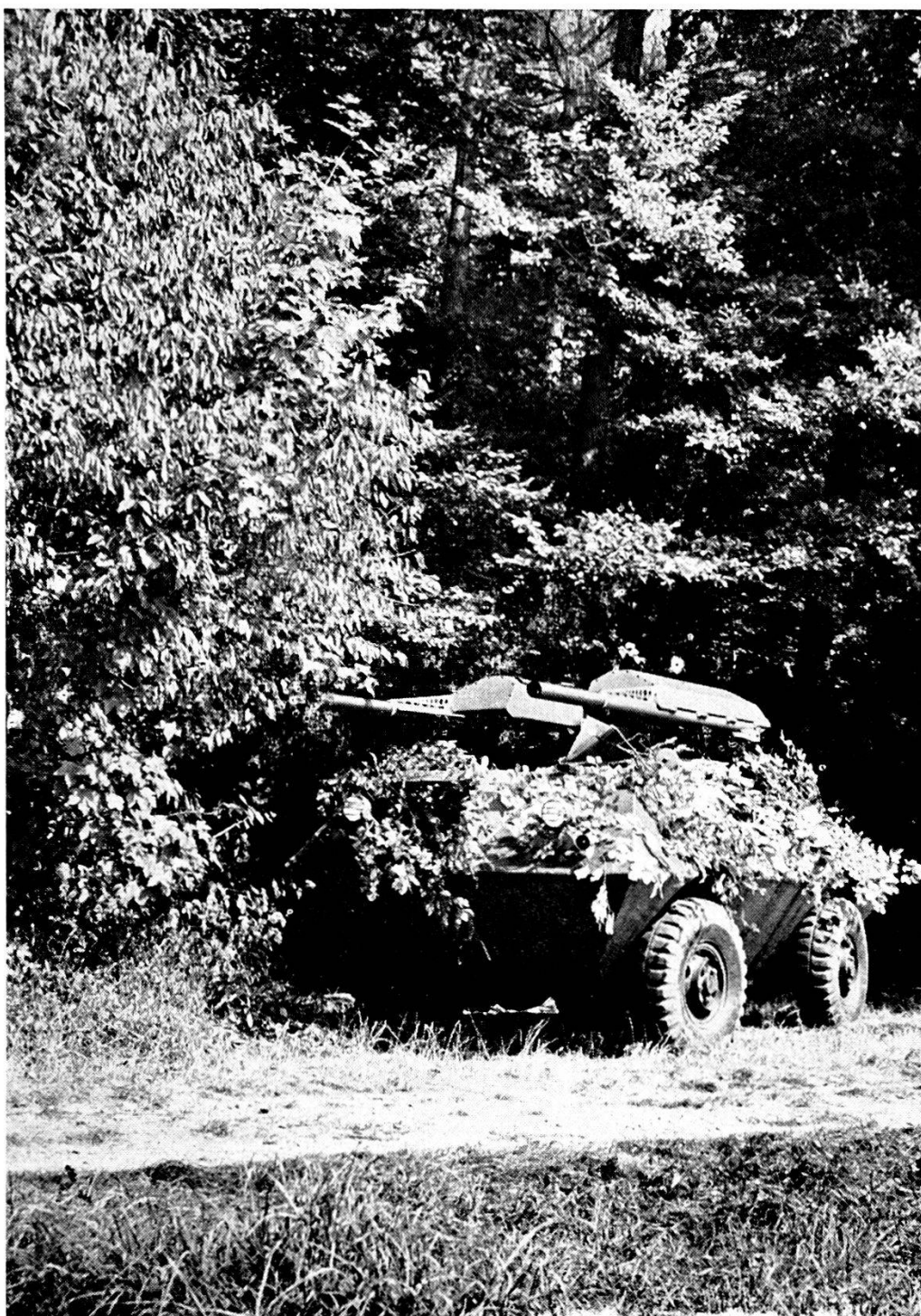
Il lanciarazzi gemellato automatico Oerlikon 8 cm. appostato per il tiro
