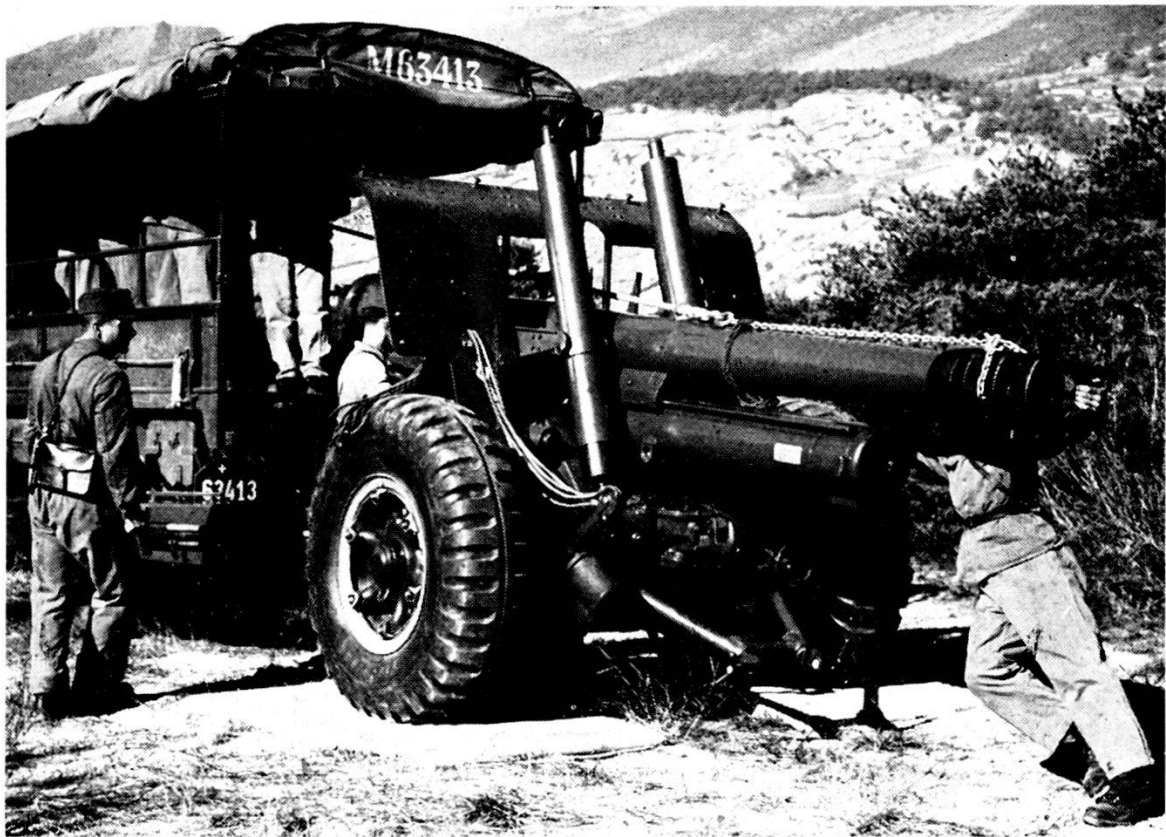
Sostituzione della canna di un obice 15 cm
