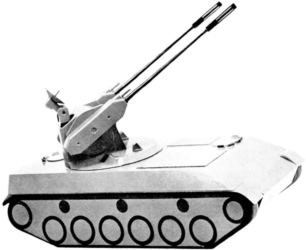
Modello di un cannone antiaereo OERLIKON a due canne calibro 35 mm. Congegno di tiro elettronico.
