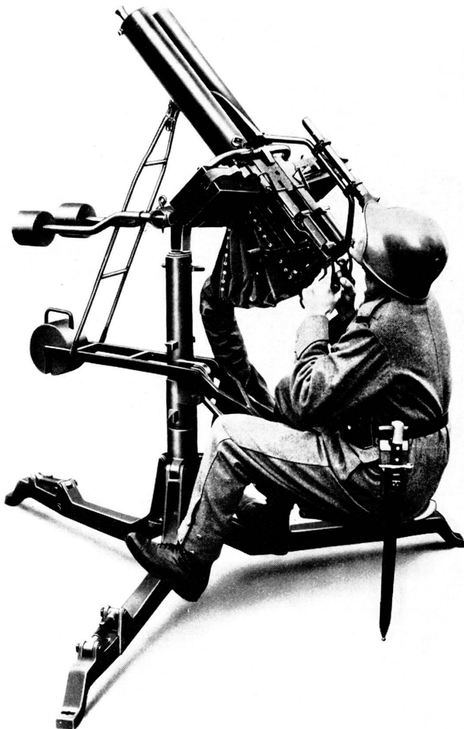
Mitragliatrice antiaerea a doppia canna modello 1938 (cadenza 2400 colpi al minuto)
