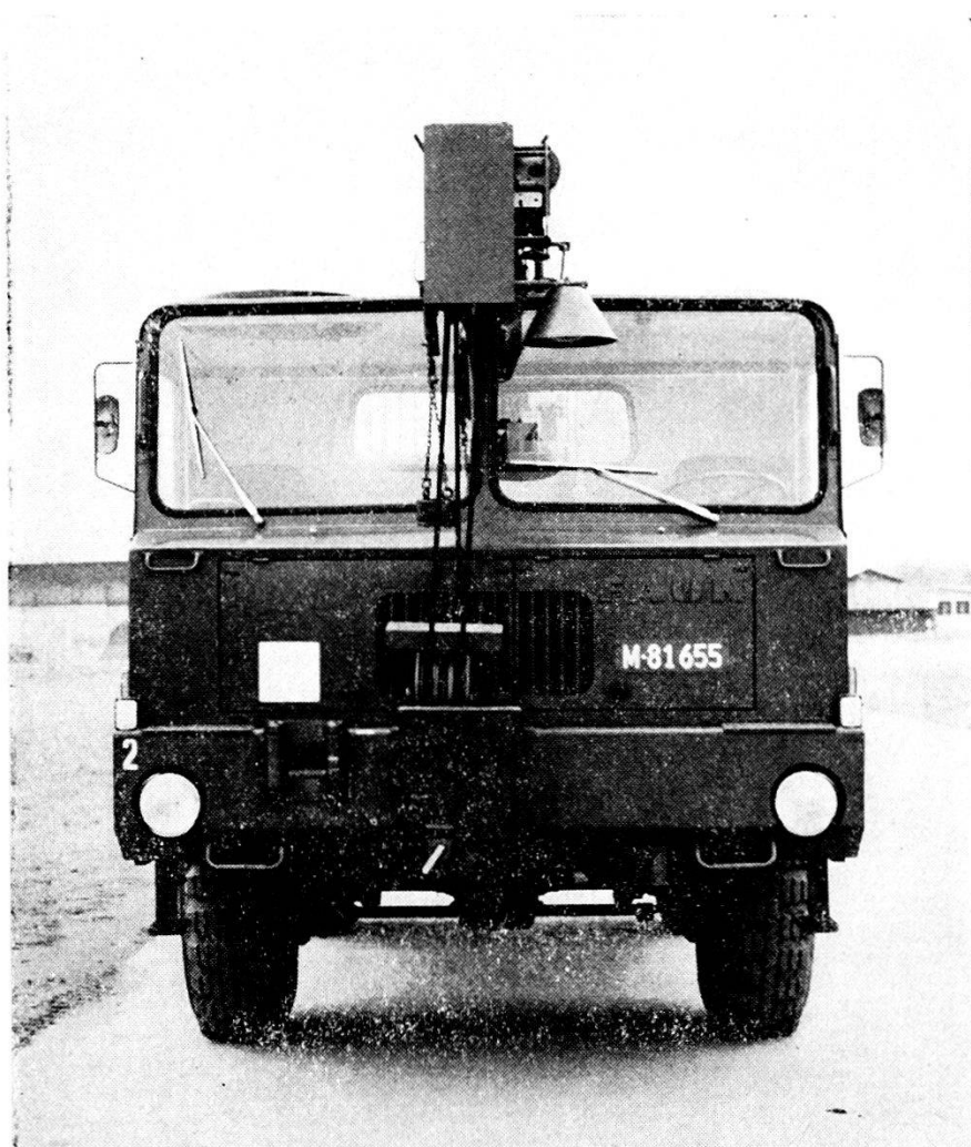
Fronte del camion gru con il braccio adagiato pronto per lo spostamento.
