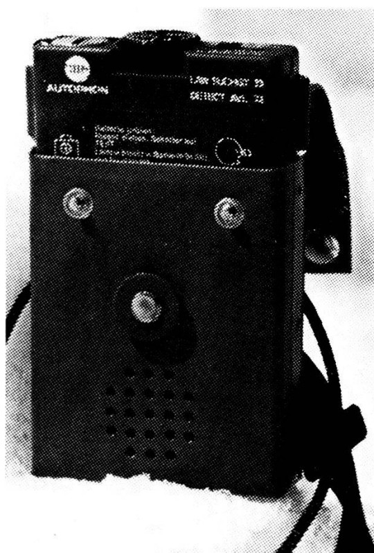
Ricercatore elettronico per travolti da valanghe.
