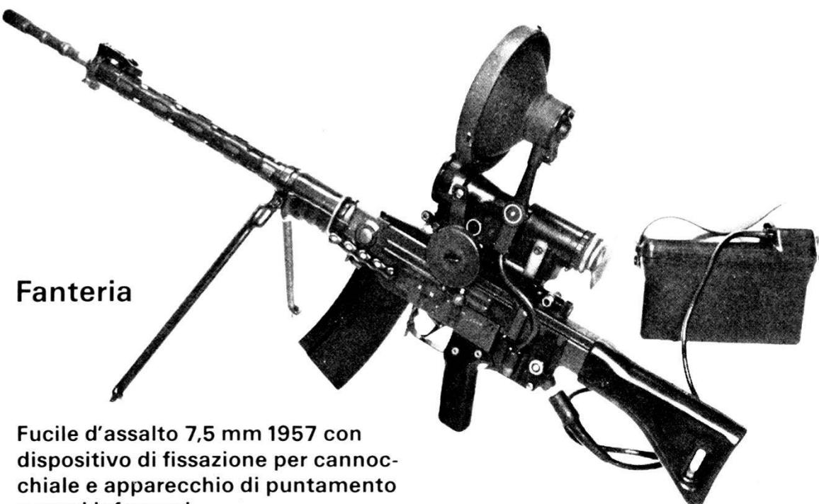
**Fucile d'assalto 7,5 mm 1957 con dispositivo di fissazione per cannocchiale e apparecchio di puntamento a raggi infrarossi
