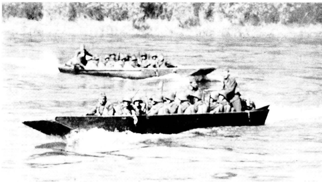
«Pontone militare mod 39 con motore fuoribordo di 45 CV».
