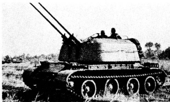
Fig. 19. DCA corazzata ZSU 57-2 a due canne calibro 57 mm, senza radar.
