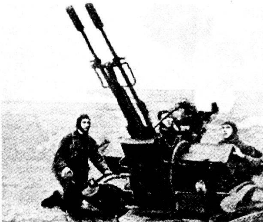
Fig. 17. Cannone DCA doppio 23 mm, in dotazione alla truppa dal 1965. Efficace nel combattimento terrestre come nella DCA a bassa quota.
