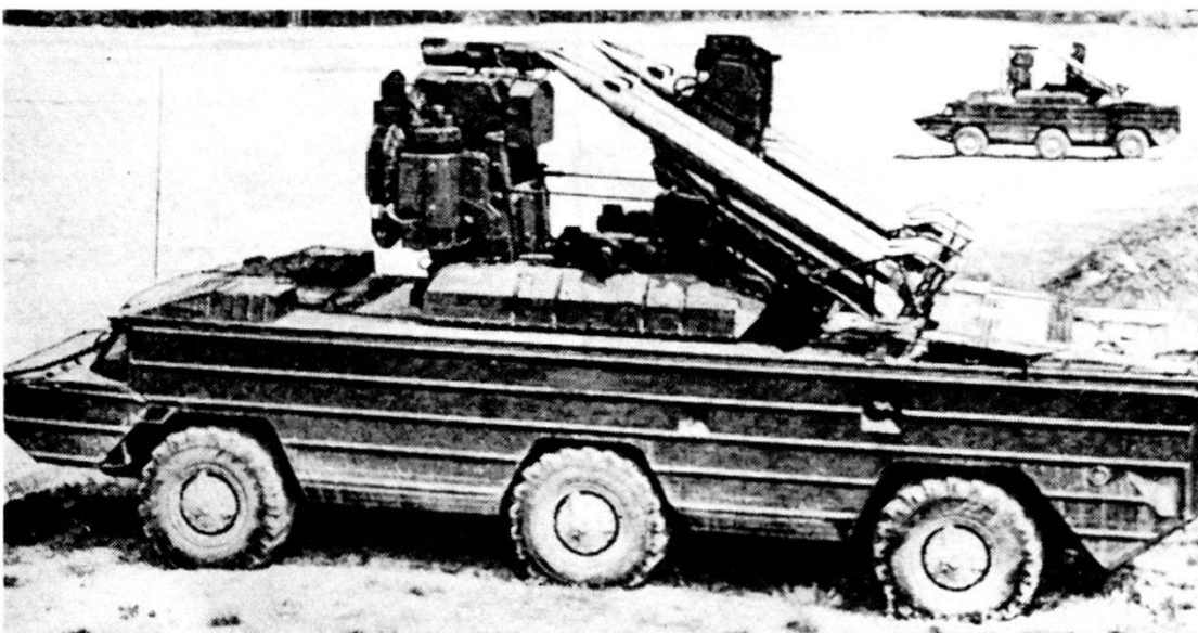
Fig. 23. SA-7 Gecko, l'ultimo modello tra i sistemi missili DCA a razzo, impiegato contro obiettivi a bassa e media quota.
