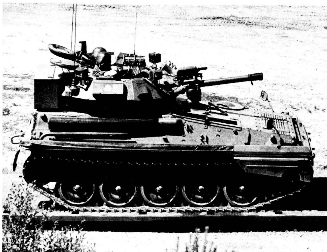
Fig. 2. Il carro leggero «Scorpion» dei reparti di esplorazione britannici. Il veicolo riprodotto è munito del simulatore di tiro «Solatron».
