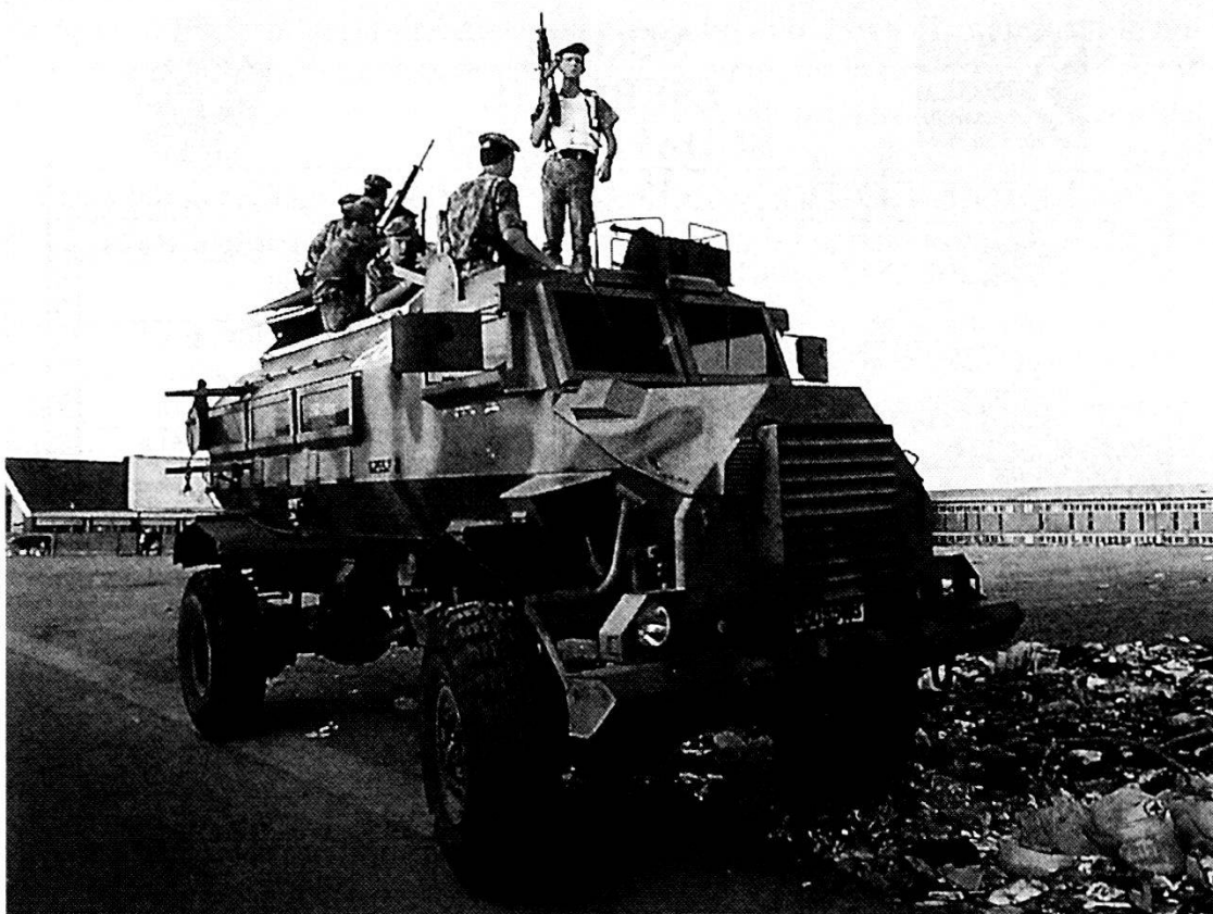
Mezzo blindato dell'esercito sudafricano. La particolare struttura del mezzo consente di ridurre i danni conseguenti all'eventuale scoppio di mine anti-carro.
