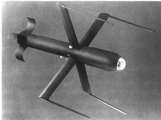
Ha una forma tutta particolare e presenta varie soluzioni tecnologiche innovative: si tratta della munizione anticarro BAT (Brilliant Anti-armor Submunition), l'ultimo sviluppo nel settore militare della ditta statunitense Northrop-Grumman. Al poligono White Sands Missile Range (New Mexico) si sono svolti recentemente con successo alcuni tiri di prova del sistema.
