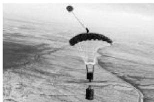
il calcolo della traiettoria e delle correzioni in volo. Come per lo "Snow Goose" anche per "Onyx" è necessario memorizzare nel computer le coordinate del punto d'atterraggio previsto prima della missione. "Onyx" è lanciato da un aereo da trasporto anche da quote elevate, fino ad un massimo di 10'700 metri sul livello del mare. Può trasportare un carico utile da un minimo di 34 kg ad un massimo di 1'000 kg.
