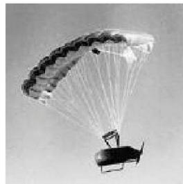
La ditta canadese MMIST ha realizzato un piccolo velivolo senza equipaggio (UAV), senza ali né timoni, sospeso ad un paracadute rettangolare (foto). Il carico utile si trova all'interno della fusoliera. L'UAV ha un motore a
