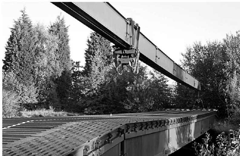
Il sistema "ponte di supporto 45 m"
