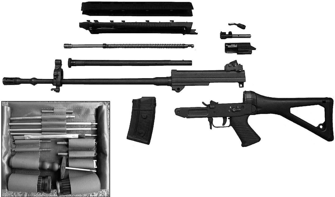
re/oliare leggermente il blocco presa gas, l'esterno della canna, l'interno della scatola della culatta in particolare le guide di scorrimento dell'otturatore, i contrafforti e la parte attorno alla camera delle cartucce. Ingrassare leggermente anche l'esterno.
