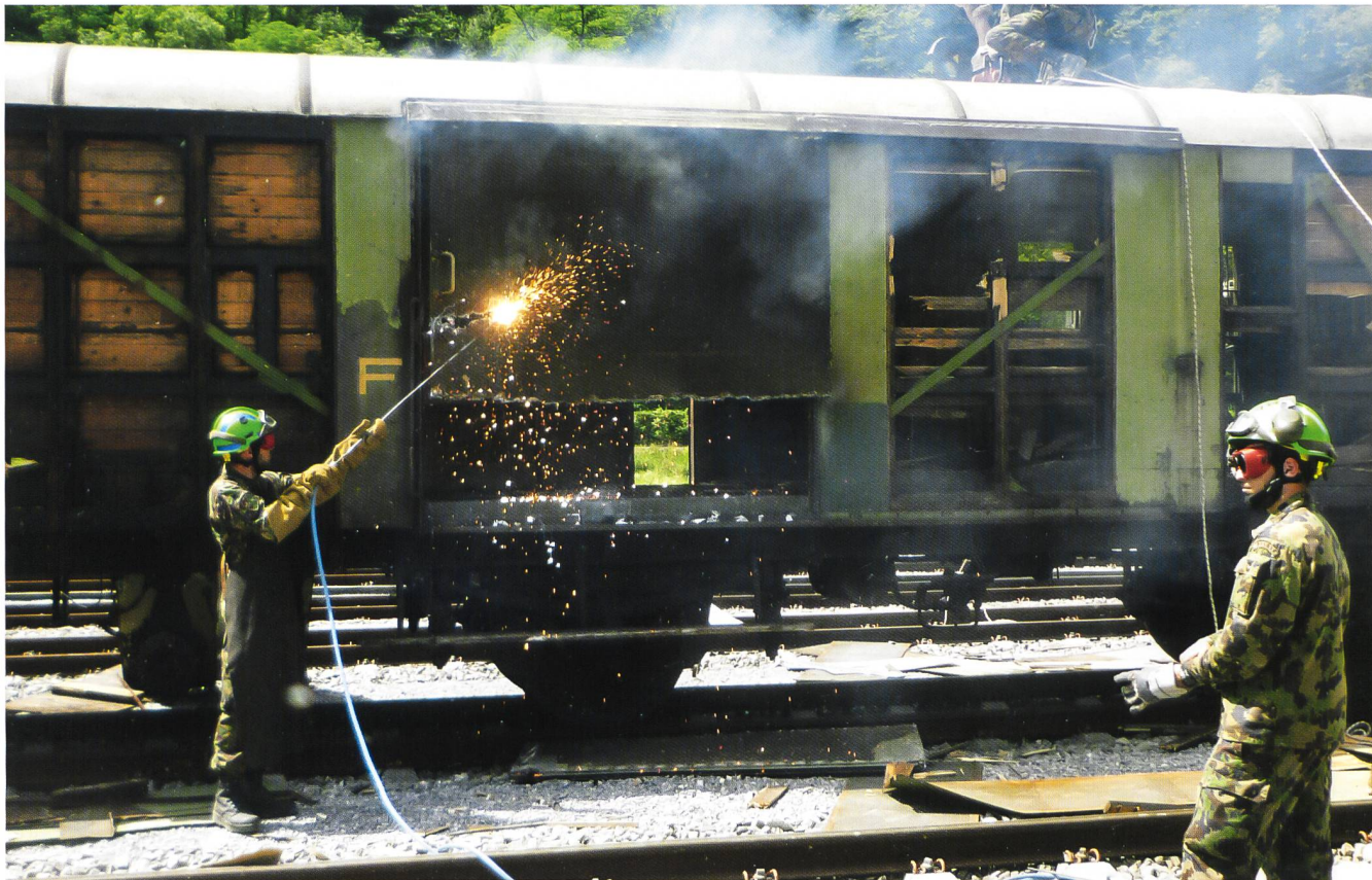
Apertura di varchi nei vagoni
