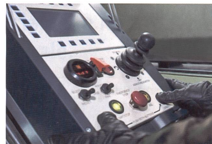
Posto di comando di tiro ( on-board-computing )
