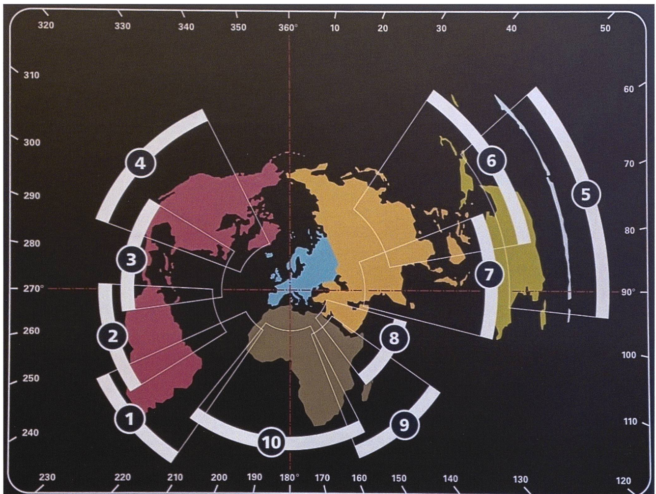
Esempio di settori di trasmissione OC sperimentati e collaudati sui quali si orienta l'antenna. In questo caso dalla stazione radio delle OC Svizzera (1932-2004). (MdR).
