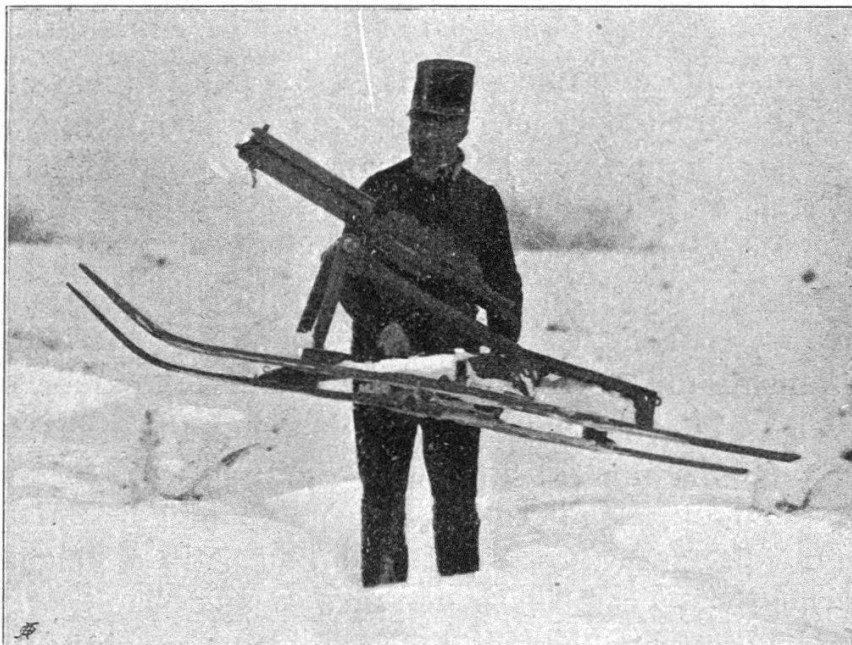
FIG. 3. — Traîneau de mitrailleuse sur skis, sorti de la fabrique d'armes de Steyr.
