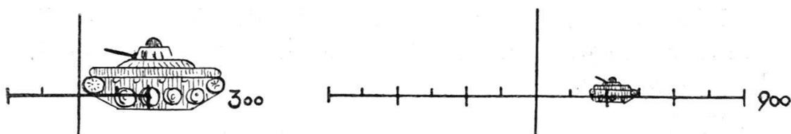
Le même char de 6 m. de long, vu à 300 et 900 m. Vitesse du char : 20 km./h.. Correction : 10 ‰.
