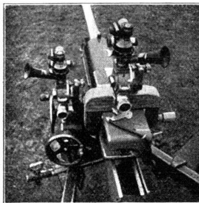
L'instructeur, l'œil à la lunette du deuxième appareil, contrôle si le pointeur exécute, rapidement et correctement, les ordres reçus.
