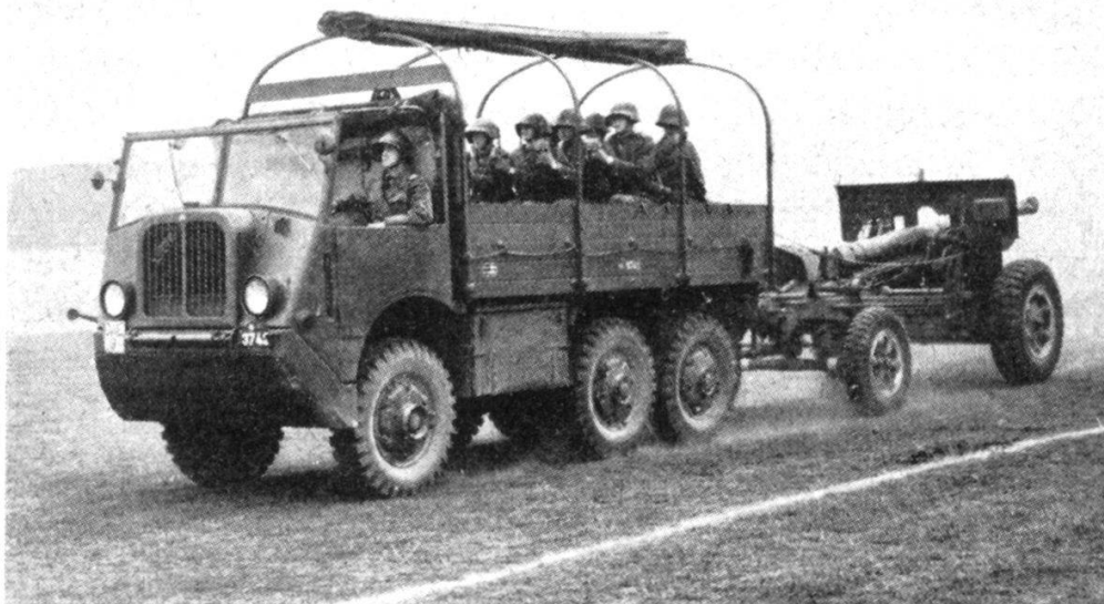
Canon lourd 10,5 cm. tracté par le Saurer M 6 introduit en 1936, encore en service.
