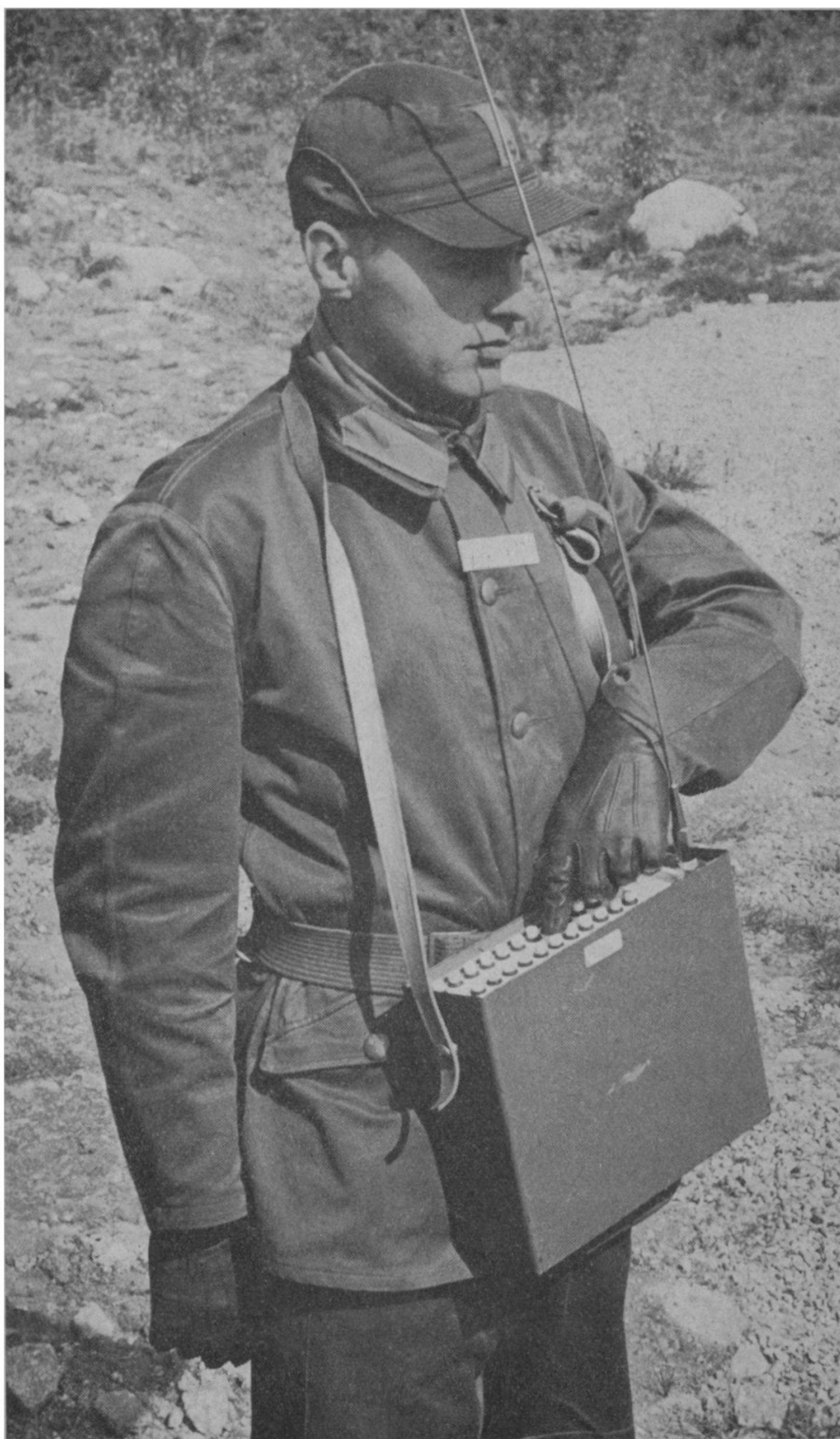
Le transmetteur BT 22 forme l'unité centrale du système et dispose de 36 canaux d'ordre différents.
