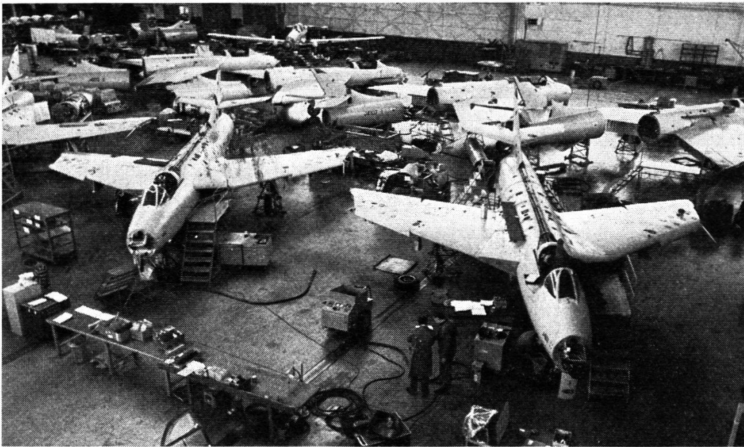
Fabrique fédérale d'avions. Montage final d'avions Hunter.
