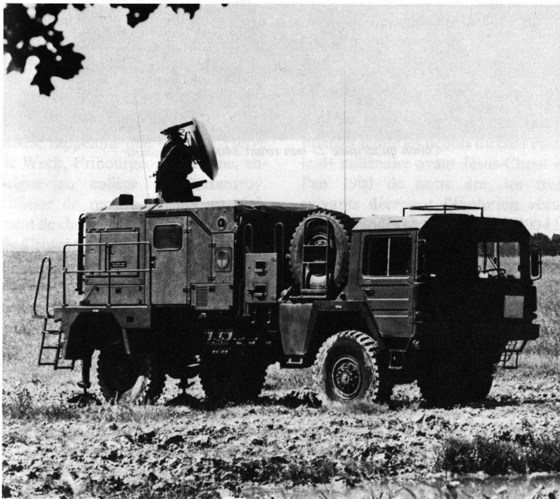
Fieldguard en position de mesure
