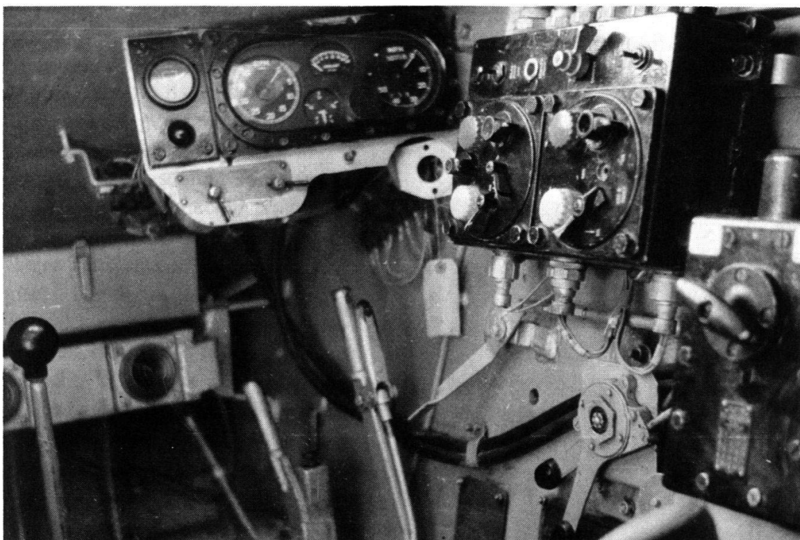
Poste de pilotage du Centurion Mark 7. De gauche à droite, on distingue le levier de vitesse, le levier de direction droite, le frein à main. Pour monter et descendre les vitesses, il faut un double débrayage. Il faut une force de 40 kg pour manœuvrer la pédale d'embrayage.
