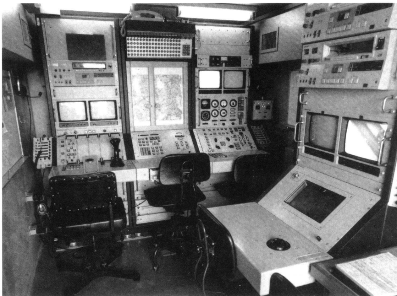
Intérieur de la station de contrôle montée dans une sorte de container. A l'arrière-plan à droite, le «poste de pilotage», à gauche, la place de travail du «cameraman»; au premier plan à droite, la place de travail de l'officier de renseignement. Fabrication israélienne par Israel Aircraft Industries Ltd (photo cdmt ADCA).
