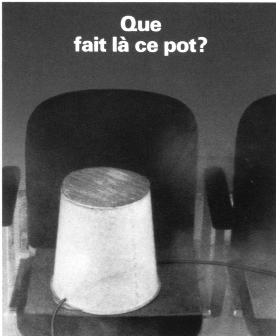
**E**n fait, ce n'est pas un pot, mais un élément d'expérimentation servant à simuler le rayonnement thermique d'un être humain. C'est à l'aide de telles simulations que Sulzer résoud les problèmes que pose l'aération des grands locaux. De quoi éviter les pieds froids aux spectateurs des théâtres et aux auditeurs des salles de concert, les têtes chaudes aux étudiants dans les amphithéâtres et les gorges sèches aux orateurs.
