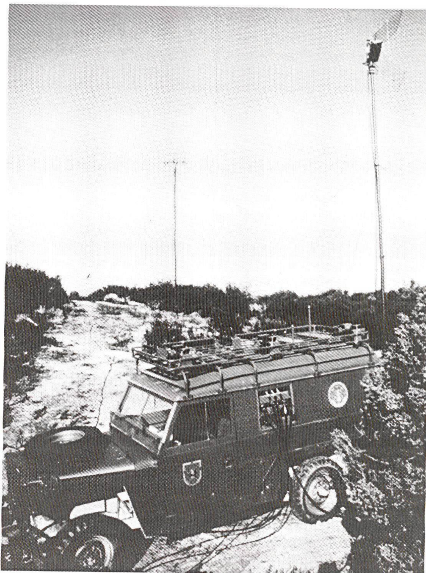
Alcatel TFH 701, faisceau herzien tactique numérique à vue directe (Photo Alcatel/Alsthom).
