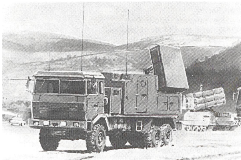
Radar de contre-batterie Cobra développé par Siemens, Thorn-Emi, General Electric, Thomson CSF (Photo Thomson CSF).
