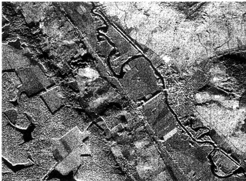
Photographie radar du terrain pour la cartographie ou la détection d'écho mobile, quelles que soient les conditions météorologiques (Photo Thomson CSF).
