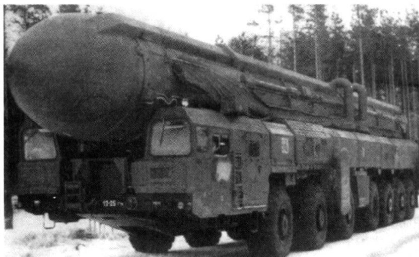
Système mobile de missile stratégique TOPOL (SS-25).
