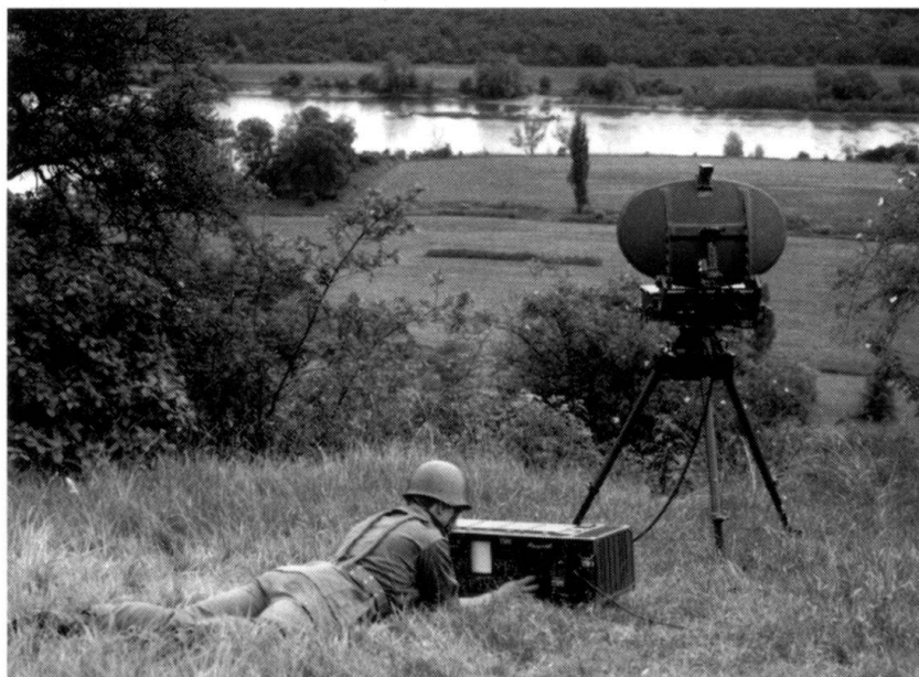
... Un Rasit français (Radar de surveillance du sol et d'aide à l'artillerie).
