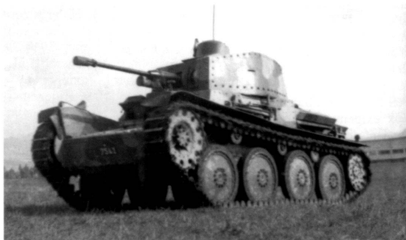
Char léger Praga (moteur diesel 105 CV mazout, vitesse 70 km/h, canon de 20 mm, 2 mitrailleuses, blindage de 5 cm). En 1940, la Suisse en aligne 24; ce sont ses seuls blindés.
