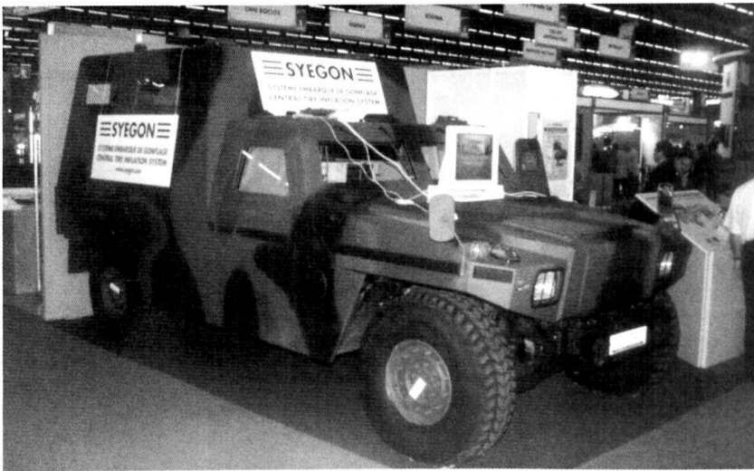
Eagle réhaussé équipé d'un système de contrôle centralisé de la pression des pneus (Syegon)
