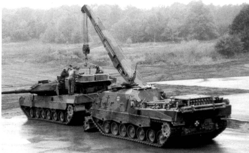
Changement du moteur d'un Leopard-2 à l'aide du char de dépannage (place d'armes de Munster).
