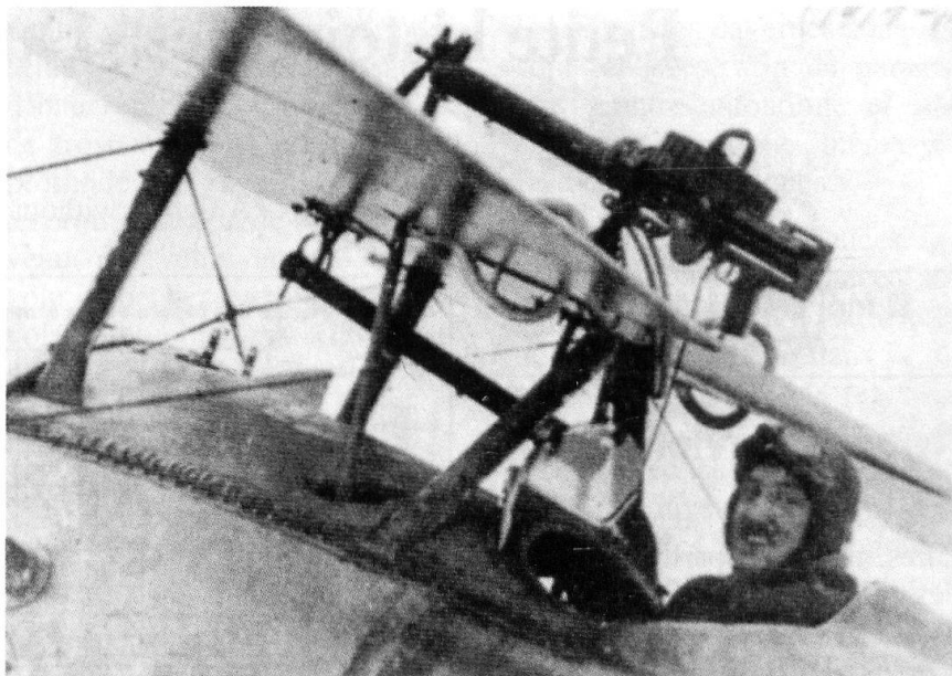
Pour éviter d'endommager l'hélice, certains appareils sont équipés en 1916-1918 d'une mitrailleuse d'extrados, escamotée vers le bas pour la manipuler.
