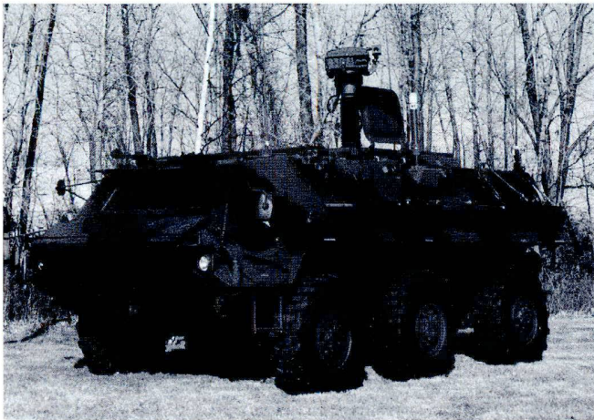
Les armées disposent aujourd'hui de laboratoires de détection et d'analyse mobiles, comme ce Spür-Fuchs de la Bundeswehr. Ce véhicule est également en service aux USA.
