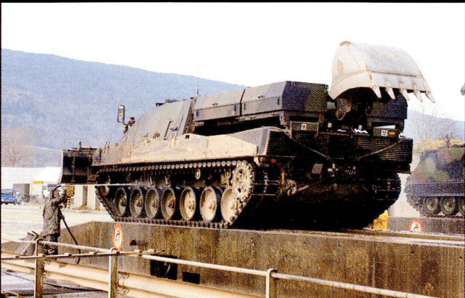
Le char du génie permet d'ouvrir des brèches en terrain meuble. Il est équipé d'une lame, d'un bras articulé et peut recevoir un système de déminage lourd.
