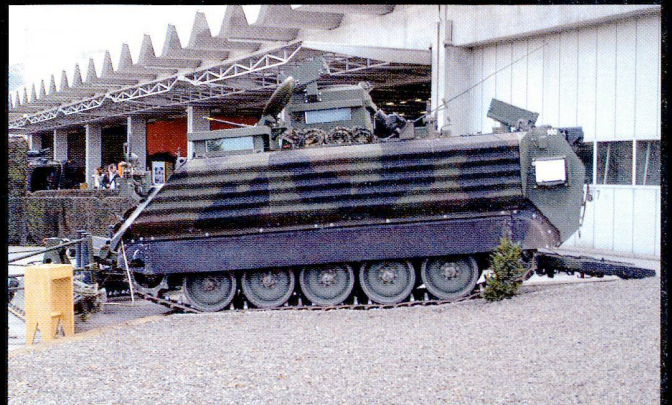
Le char de déminage léger 90 est en mesure d'ouvrir, de déblayer et de faire détonner des mines sur surface dure.
