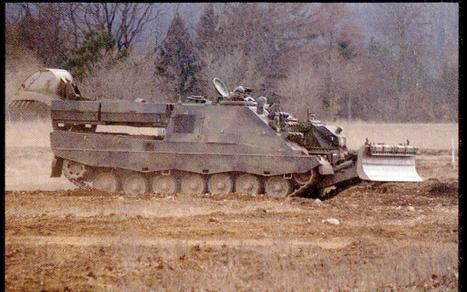
Le char du génie permet d'ouvrir des brèches en terrain meuble. Il est équipé d'une lame, d'un bras articulé et peut recevoir un système de déminage lourd.
