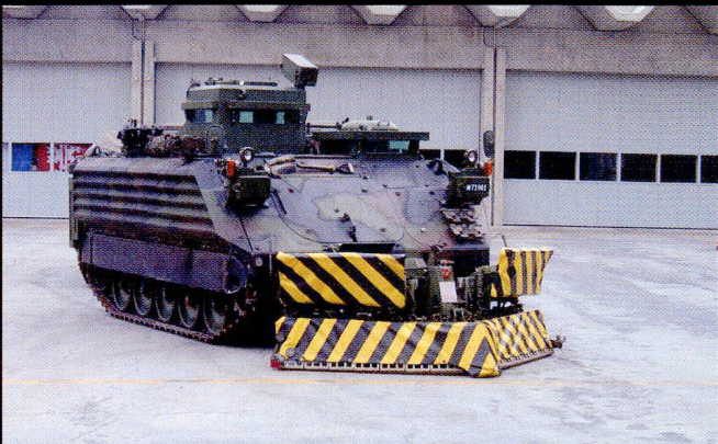
Le char de déminage léger 90 est en mesure d'ouvrir, de déblayer et de faire détonner des mines sur surface dure.
