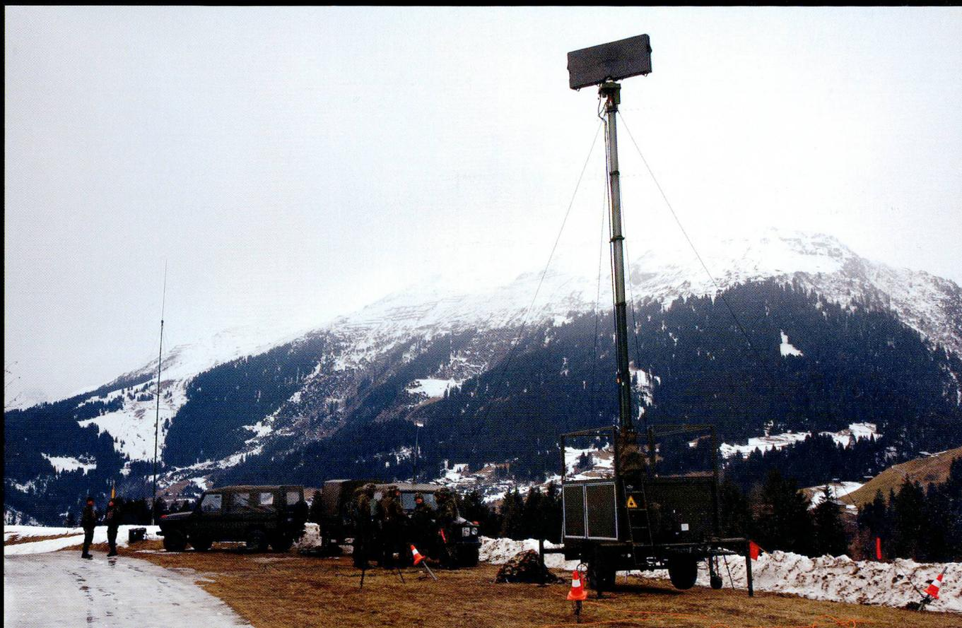
Le système radar *Alert* est un multiplicateur de forces pour l'engagement du système d'engin guidé léger DCA *Stinger*. En permettant la veille quelles que soient les conditions de visibilité et météorologiques, il permet un engagement optimal et à temps des unités de feu.
