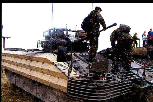
Le Bulldog surblindé répond à la demande des troupes légères britanniques en Afghanistan d'augmenter le niveau de protection.
