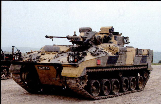
Le MRCV80 livré d'usine, pèse 24,5 t. On aperçoit sur son flanc le volumineux système de filtration d'air NBC.
