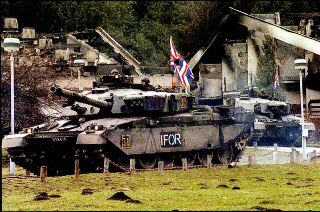
420 Challenger 1 ont été construits à partir de 1986. Ils pèsent 62 tonnes et sont armés d'un canon de 12 cm approvisionné à 62 coups.
