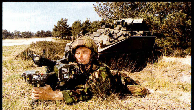
Les engins guidés Swingfire , du chasseur de chars Striker peuvent être télécommandés depuis un couvert à proximité du véhicule
