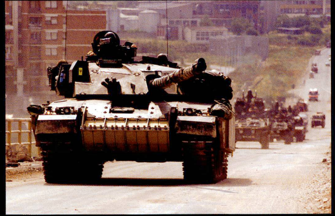
Les Challenger 1 déployés dans le Golfe et dans les Balkans ont reçu des surblindages latéraux à partir de 1992.
