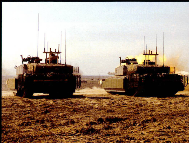
Dernière revalorisation en date : le blindage a une nouvelle fois été augmenté; les chars ont été équipés de 4 postes radio.
