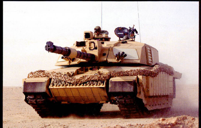
Le Challenger 2 a, comme son aîné, lui aussi reçu des kits de surblindages, faisant passer le poids à 67,5t pour 1'500 PS.
