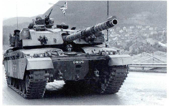
Le Challenger 1 reprend la tourelle et l'armement du Chieftain , avec une carcasse plus moderne et un blindage composite.
