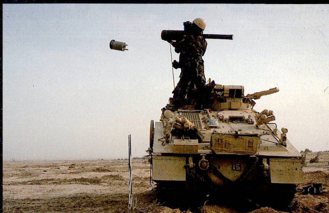
Le Spartan compte 2 membres d'équipage et de la place pour 5 à l'arrière. Il peut ainsi emporter deux équipes DCA Javelin .
