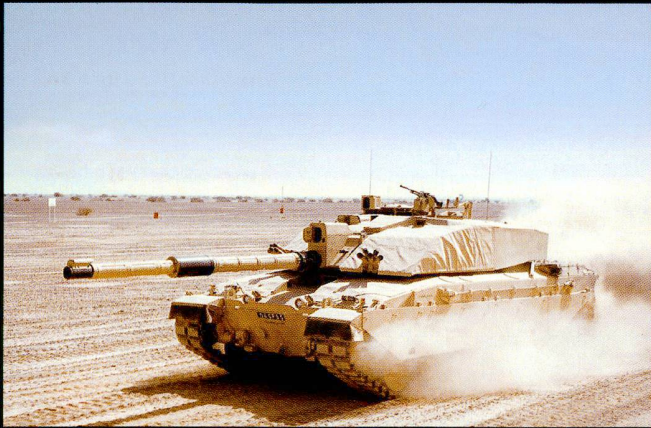
446 Challenger 2 de 62,5t ont été produits à partir de 1988. Leur moteur V12 diesel MTU et leurs chenilles sont les mêmes que le Léopard 2.
