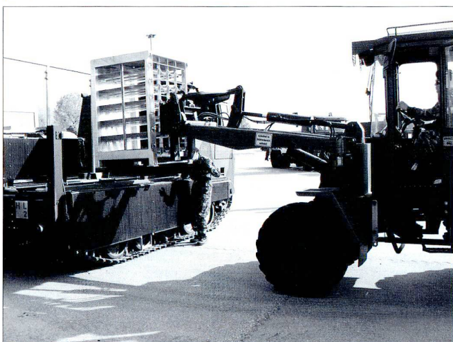
Un FUG charge le rack sur le transport de munitions chenillé M-548.
