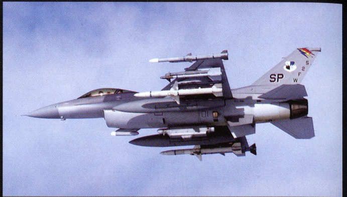
Le Falcon plus léger et moins cher, a été décliné en appareil de guerre électronique ( Wild Wease ), le F-16 CJ.
