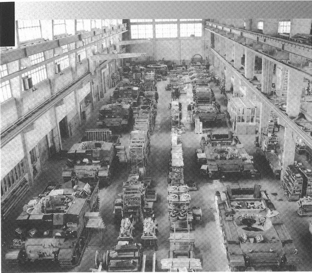
La halle d'assemblage des ateliers de construction fédéraux de Thoune (K+W), circa 1965. On y trouve en parallèle (à gauche) les chars de dépannage sur châssis Centurion et à droite les chars 68 AA3 à « petite » tourelle.
