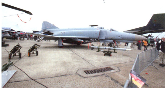
Le F4F revalorisé (ICE) reçoit un nouveau radar ainsi qu'un armement air-air sensiblement plus performant, sous la forme de l'AIM-120 AMRAAM présenté sous le ventre de ces deux appareils.
