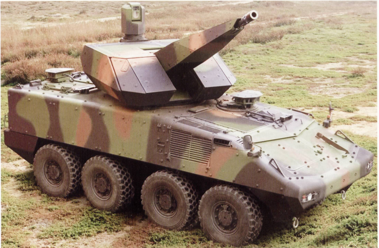
Le Skyranger d'Oerlikon est un système Ahead 35 mm monté sur un châssis de Piranha IV.
