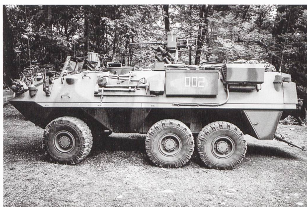
Le nouveau char de cdm Piranha 6x6 avec sa mitr 12,7 en tourelle télé-opérée.
