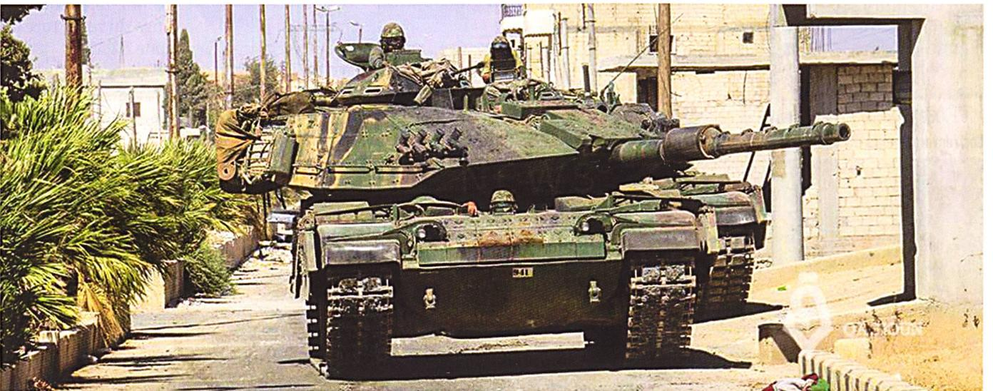
Mieux blindé et disposant d'un armement aujourd'hui très performant -le canon de 12 cm L44 produit sous licence de Rheinmetall- permet aux nouvelles versions du M-60 de fournir un appui de feu précis et puissant aux unités de l'armée turque.
